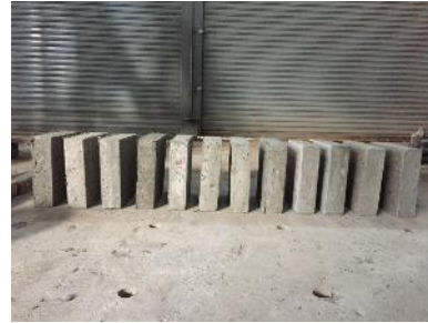
Fig. 5: Specimens size 30x30x8 cm 2
