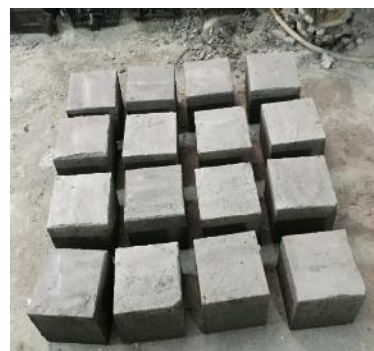
Fig. 3: Specimens size 15x15x15 cm 3
