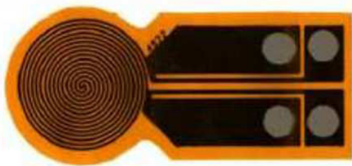
Fig. 2: Hot Disk Sensor Ref 4922
