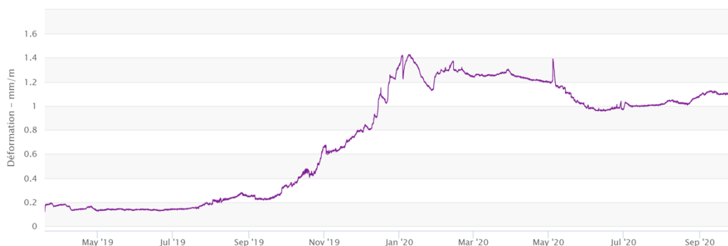
FIGURE 3. Exemple de mesure correspondant à l'évolution locale d'un désordre, après correction thermique.
