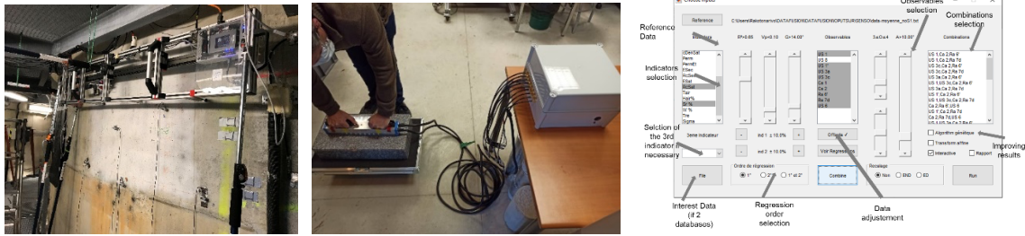
Figure 5. Robot US par ondes de surface à traducteurs aériens / contacts secs, logiciel de fusion interactif
