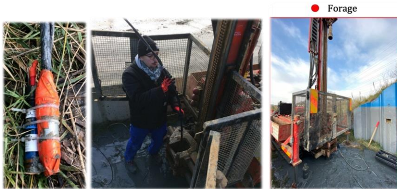
FIGURE 4. Électrode de référence Cu-CuSO 4 montée sur perche semi-rigide (à gauche) et mesure de potentiel en forage (à droite)
