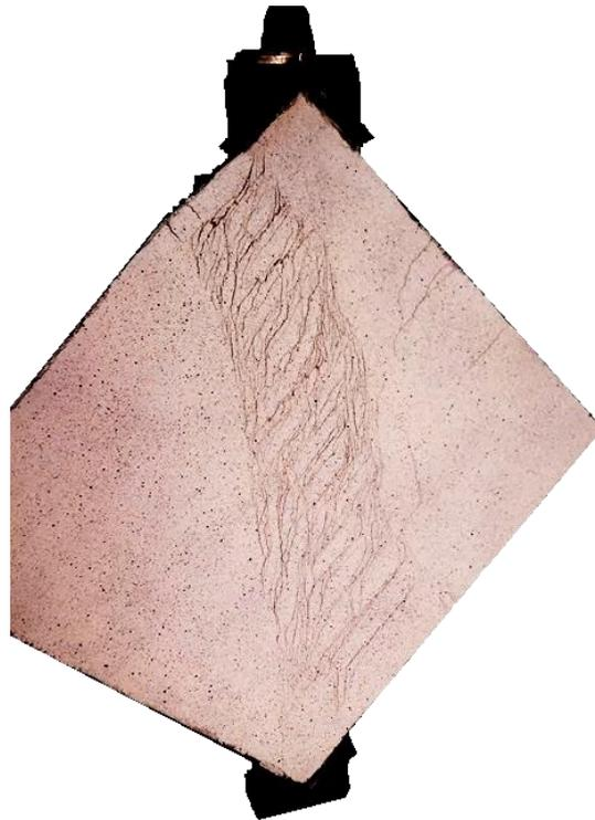
**FIGURE 4.** Mode de ruine des murs en maçonnerie renforcé par le system composite Flax TRM.
