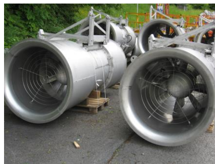
FIGURE 9. Principes des différents systèmes de ventilation, à gauche, et accélérateurs avant installation, à droite [Charles, Yaghzar, D'Aloia 2020].
