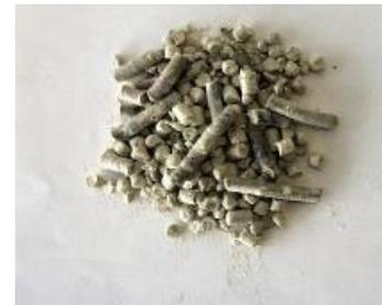
**FIGURE 1.** Polyuréthane sous forme de granulés (PUG)
