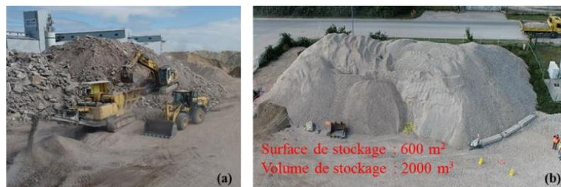
FIGURE 1. Fabrication (a) et stockage (b) des GR sur la plateforme de recyclage Valosphère
