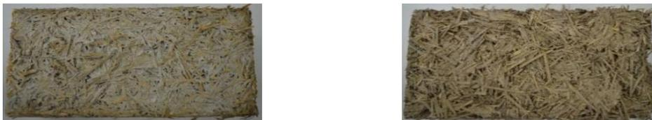
**FIGURE 1.** Matériaux biosourcés à base de paille : MAT1 (à gauche) et MAT2 (à droite)
