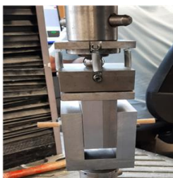
FIGURE 4. Montage expérimental (à gauche) et aspect de la cheville à la fin de l'essai (à droite)
