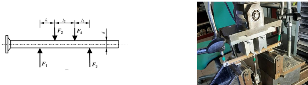
FIGURE 2. Dispositif expérimental pour essais de flexion sur chevilles circulaires en chêne
