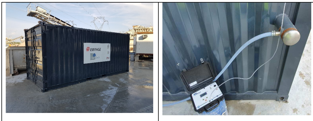
FIGURE 4. Vue du conteneur Clamens et de son système d'injection.
