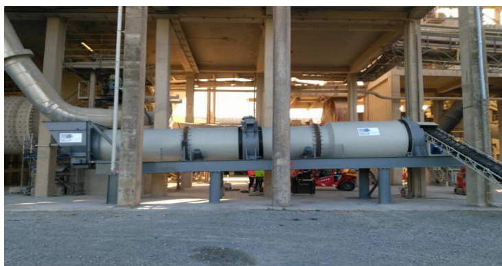
FIGURE 2. Pilote FastCarb – Tambour sécheur, usine Vicat de Créchy (Allier)
