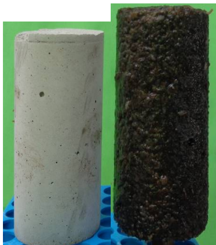
FIGURE 6. Photographies d'un échantillon de mortier à base de CEM I avant exposition (à gauche) et après 26 mois d'exposition (à droite) permettant d'apprécier le développement du biofilm en surface du matériau.
