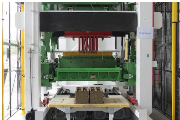
FIGURE 2. Presse vibrante du Cerib
