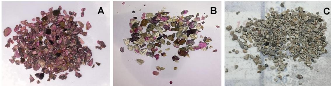
**FIGURE 6.** Mise en évidence de l'état de carbonatation initiale par pulvérisation de phénolphthaleïne
