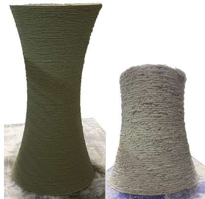
FIGURE 8. Impression 3D d'une hyperbole de 1m de haut, formule B à gauche, formule M4 à droite
