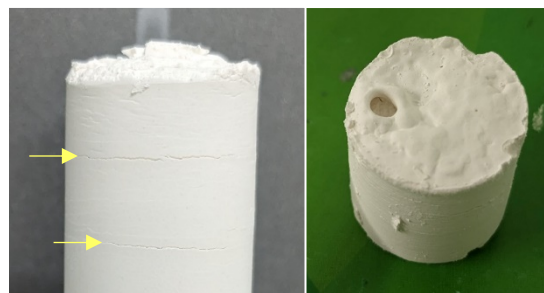
FIGURE 7 : Fissures et remontée de bulles dans la poudre de lors de l'imbibition
