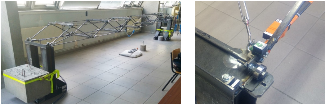
FIGURE 4. Maquette tridimensionnelle et zoom sur un capteur d'appui.
