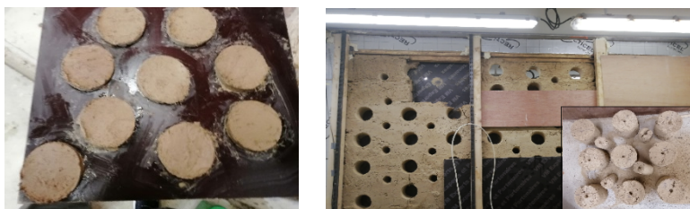
FIGURE 1. Echantillons de perméabilité à la vapeur d'eau fabriqués (échelle du matériau) et parois carottée
