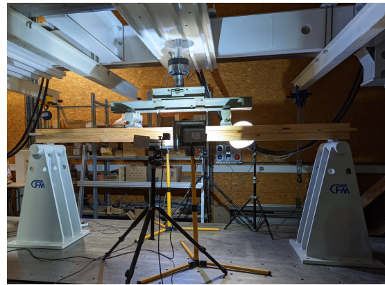
FIGURE 7. Montage de l'essai de flexion quatre points
