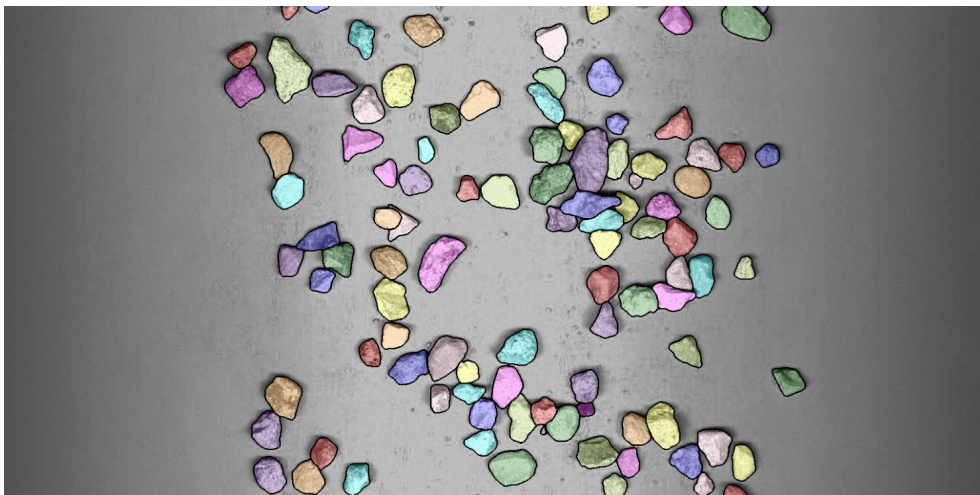
FIGURE 4 : segmentation d'une image contenant de nombreux granulats. Chaque granulat est coloré pour mieux l'identifier. Les contours sont en noir.
