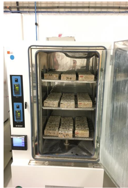
FIGURE 1b. disposition des primes dans l'enceinte climatique à 45°C et 92% d'humidité relative
