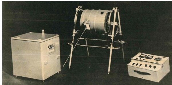
FIGURE 1. Vue d'ensemble du Bétatron (bloc d'alimentation à gauche, émetteur au centre et pupitre de commande à droite)
