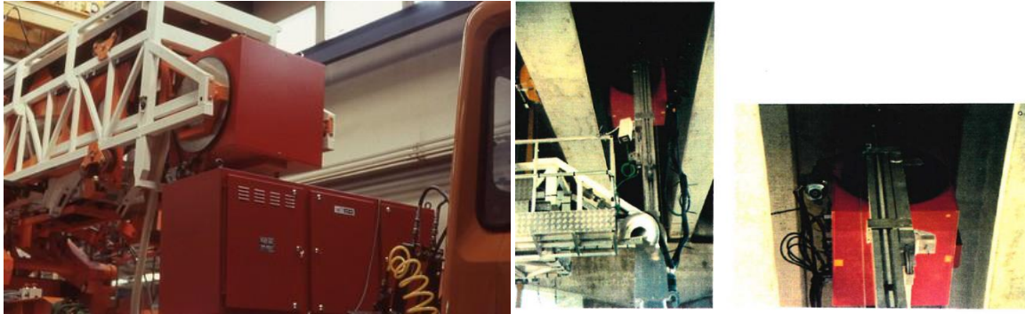
FIGURE 7. Modification de l'installation de la tête d'irradiation sur le support manipulateur : première version à gauche (mouvement de rotation uniquement) et nouvelle version à droite (déplacement vertical et mouvement de rotation)
