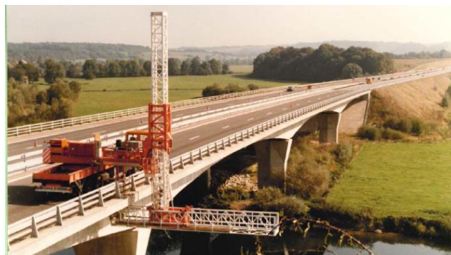
FIGURE 5. Support manipulateur en place sur un ouvrage
