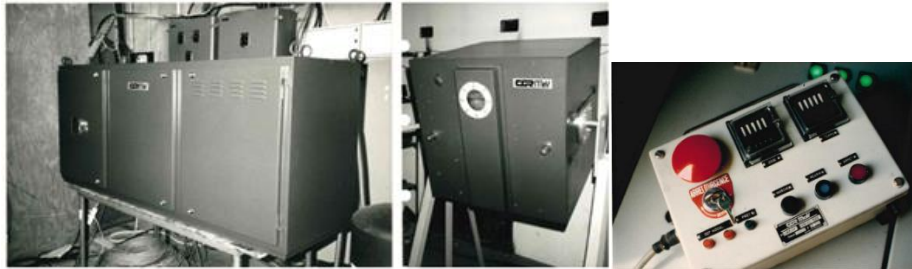
FIGURE 4. Différents éléments du Neptune 4: baie technique (à gauche), tête d'irradiation (au centre) et boîtier de commande (à droite)
