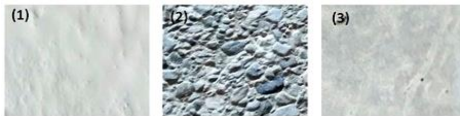
FIGURE 1. traitement des surfaces des substrats: 1: sans traitement et renforcée par un agent adhésif, 2: traitée par sablage, 3 : non traitée.
