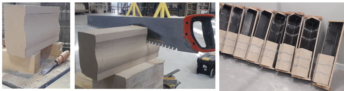
FIGURE 1. (a) Taille des sommiers au ciseau droit (b) Coupe au zag et (c) Éprouvettes assemblées dans des gabarits.
