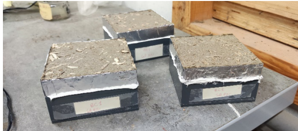
FIGURE 1. Assemblages de l'essai de perméabilité à la vapeur d'eau
