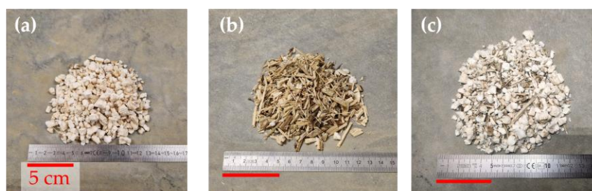
FIGURE 2. Granulats en vrac : moelle de tournesol (de référence) (a), écorce pure (b) moelle très impure (MTI) (c).
