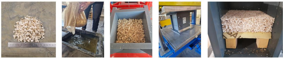
FIGURE 5. Procédé de fabrication d'un panneau à base de moelle de tournesol.
