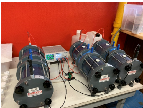
FIGURE 1. Dispositif utilisé pour la détermination du coefficient de diffusion apparent D_{\text{rcm}}
