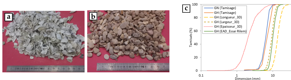
FIGURE 2. Présentation des granulats utilisés. a/ Coquilles d'huitres concassées (GH), b/ Granulats classiques (GN), c/ Etude granulométrique comparative de GH et GN
