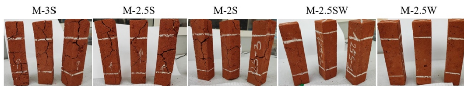
FIGURE 4. Faciès de rupture des éprouvettes après le cycle chauffage/refroidissement de 800°C.
