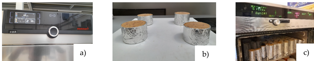
Figure 2 : Dispositif expérimental pour la carbonatation : a) étuve, b) échantillon avec une face exposée, c) enceinte de carbonatation
