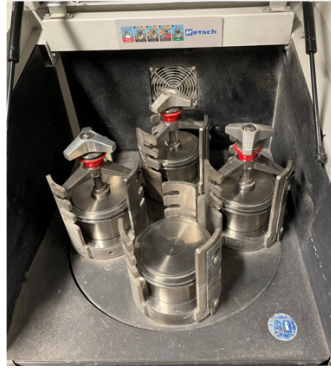
FIGURE 1. Broyeur planétaire à bille – 4 jarres
