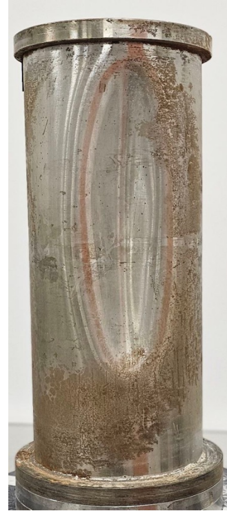
FIGURE 11 : Déformée du cylindre pour l'essai E2_fc= 0,48
