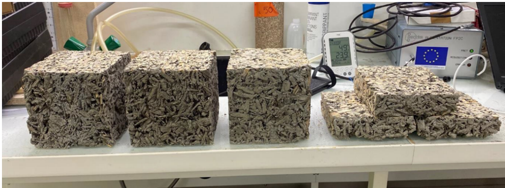
FIGURE 3. Les bétons de bois préparés sous deux formes géométriques : cubique et parallélépipédique
