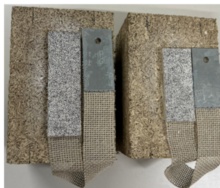
Figure 5. Préparation des éprouvettes FRCM/béton végétal
