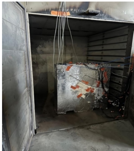
FIGURE 3. Vue du démonstrateur dans l'étuve avant le lancement de la campagne de séchage à 45 °C.
