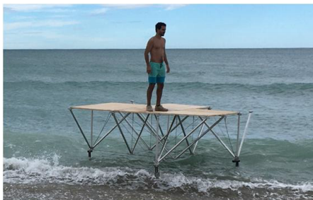
FIGURE 1. Module de ponton en situation de test pour l'accès à la mer pour tous
