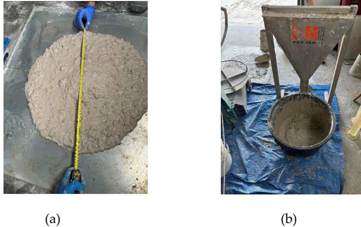
Figure 1 . Essais de caractérisation de la rhéologie de l'écobéton de terre : (a) étalement et (b) vitesse au Funnel
