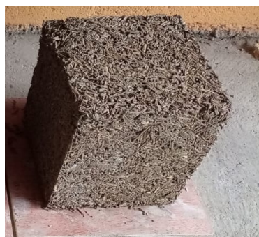
Figure 1. Béton biosourcé démoulé
