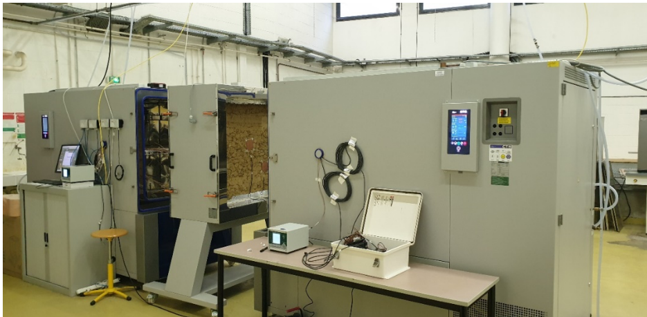
FIGURE 1. Image du mur en bauge entre les 2 enceintes climatiques
