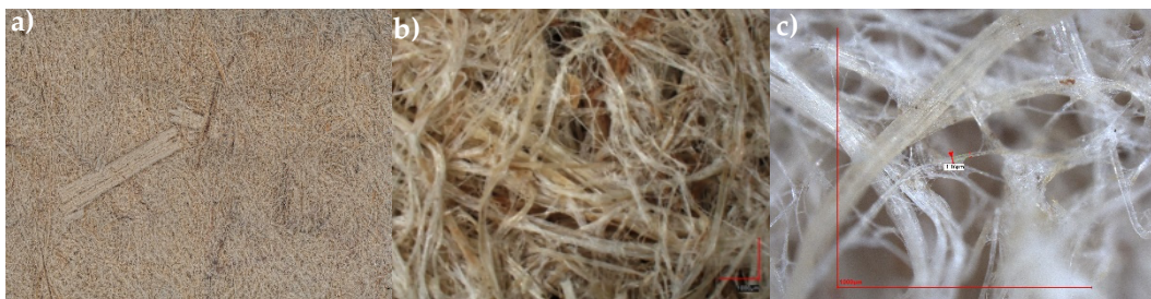
FIGURE 5.a. Images microscopiques du géotextile en chanvre non vieilli à différents grossissements a) X20 ; b) X100 ; c) X200
