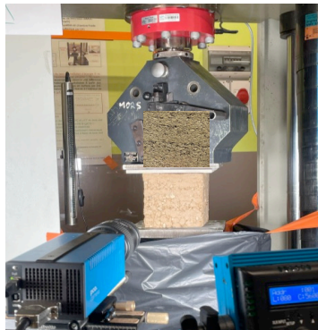
Figure 2. Dispositif de compression cyclique et installation CIN
