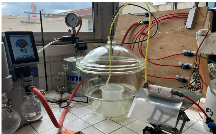
FIGURE 2. Dispositif d'injection sous vide pour l'injection de la solution de traitement
