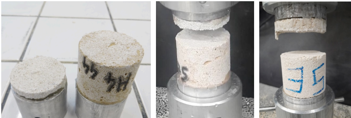
FIGURE 5. Exemple de rupture adhésive entre la pierre et le mortier
