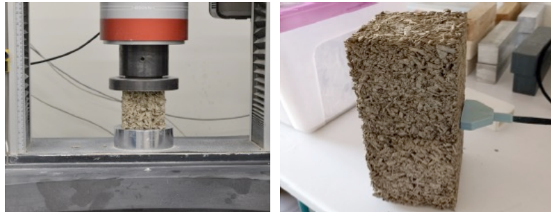
FIGURE 2. Test de compression uni-axiale (à gauche), test de conductivité thermique (à droite)
