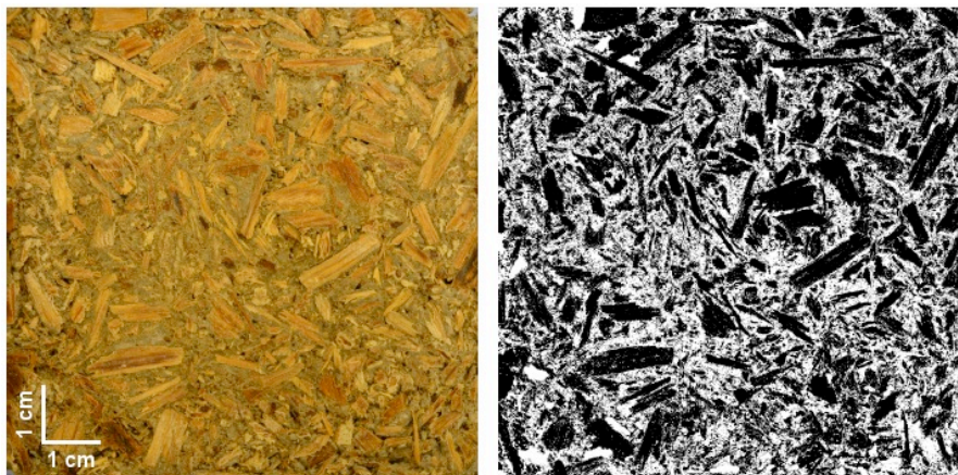
FIGURE 6. Exemple d'image de la face transversale des biocomposites avant et après seuillage.
