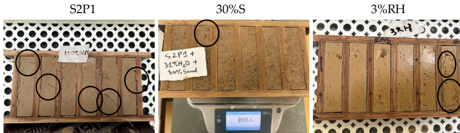
FIGURE 5. Fissurations observées au démoulage sur les éprouvettes formulées
