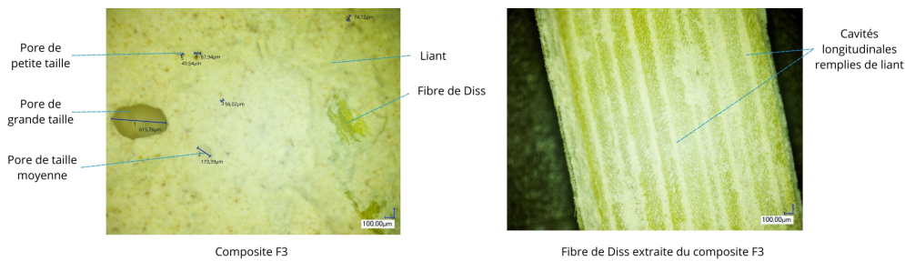
FIGURE 3. Image microscopique du composite F3 âgé de 56 jours, d'une fibre de diss extraite de F3
