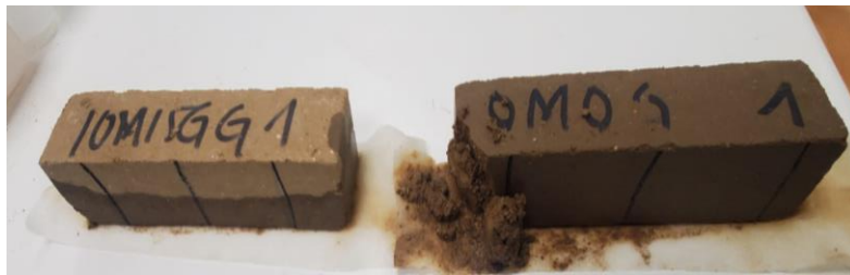
FIGURE 5. BTC après 24h d'absorption d'eau par capillarité
