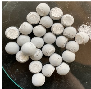
FIGURE 1. Échantillonnage de billes moulées MR20-m (15 mm)
