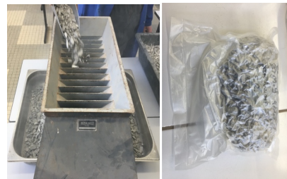
FIGURE 2. Quartage des mortiers concassés et mise sous vide MR20-c
