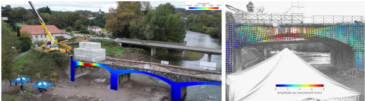
FIGURE 3. Pont d'Osserain pendant le chargement : projection des champs de déplacements sur la structure obtenus par la modélisation (à gauche) et par la corrélation d'images (Navier) (à droite)
